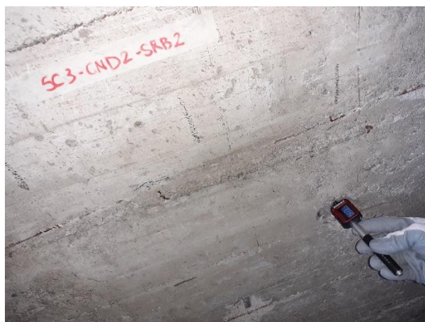
Prove con durometro su barre d'armatura
