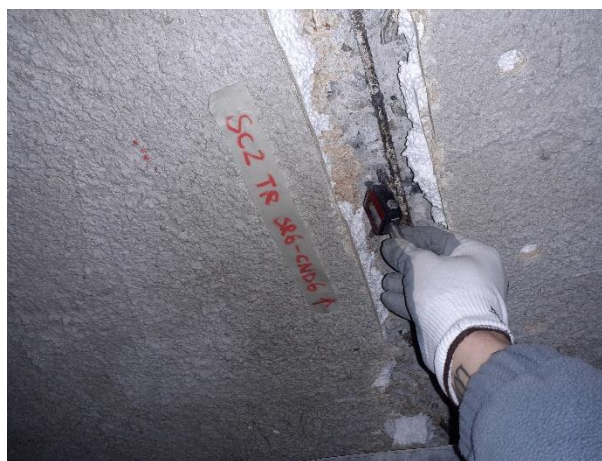
Prove con durometro su barre d'armatura
