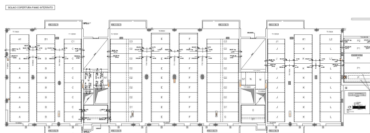
STRUTTURE IN C.A.: CARPENTERIA IMPALCATO
