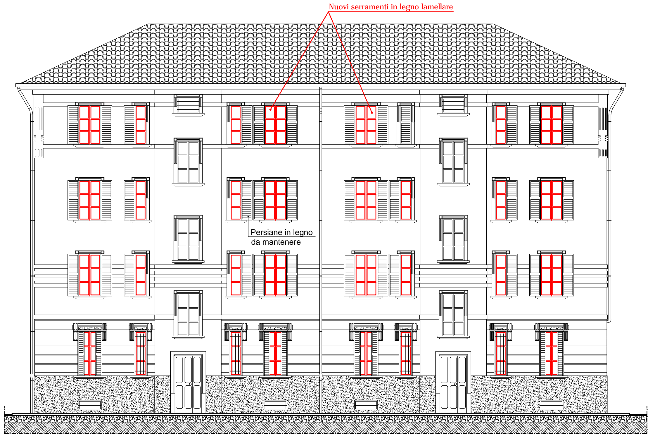
PROSPETTO TIPO - NORD-OVEST - scala 1:100
