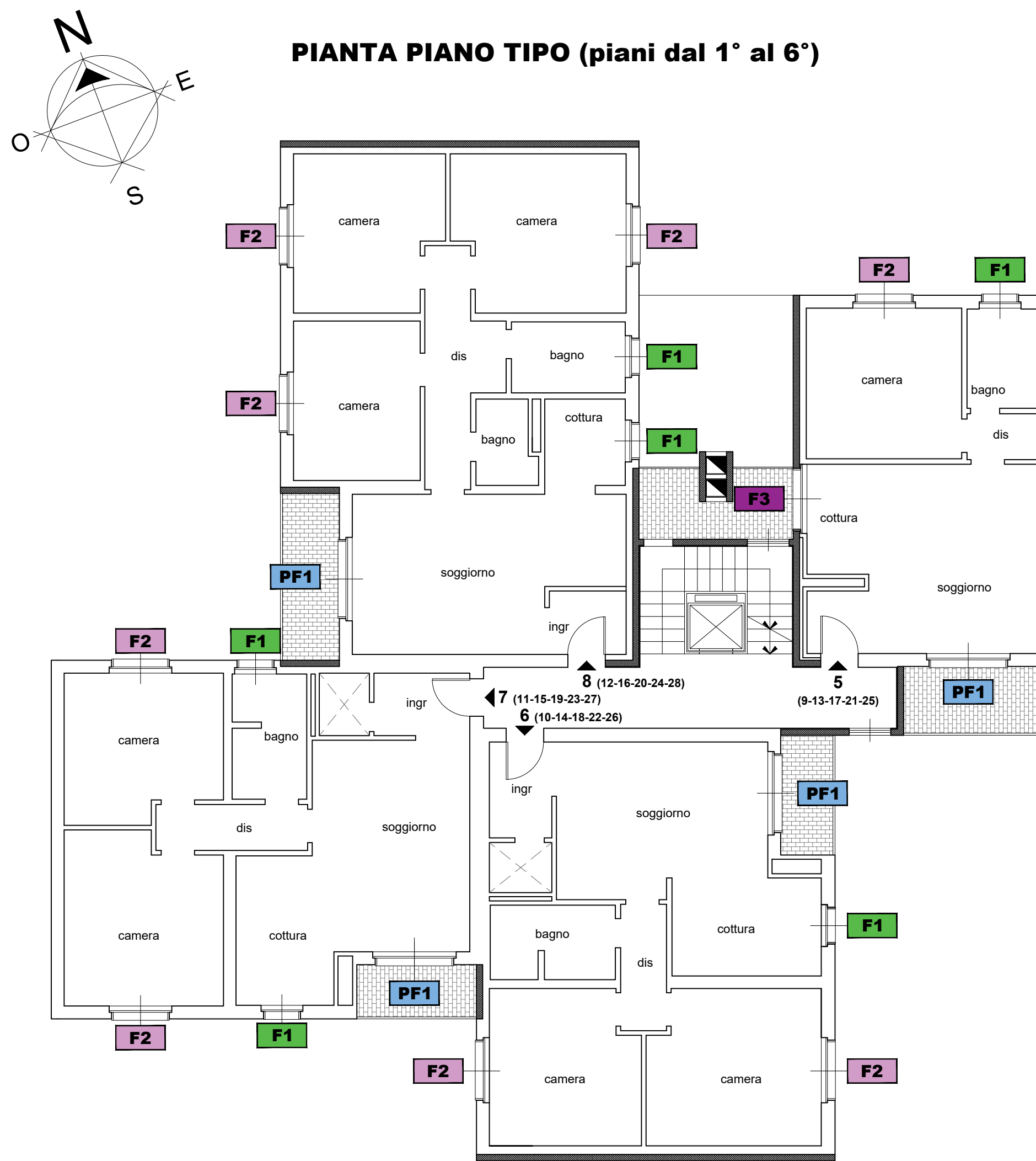
SERRAMENTI OGGETTO DI SOSTITUZIONE:
